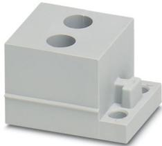
Isolatori passanti, piccoli, numero dei conduttori: 2, esecuzione: Cavo a sezione circolare, intagliato, diametro esterno conduttore: 2x 5 mm ... 6 mm, materiale: SEBS (senza alogenati), colore: grigio, lunghezza: 29,5 mm, larghezza: 19,5 mm, altezza: 17 mm
