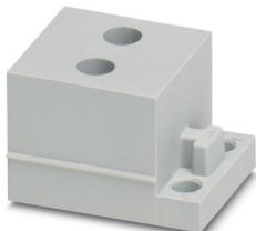
Isolatori passanti, piccoli, numero dei conduttori: 2, esecuzione: Cavo a sezione circolare, intagliato, diametro esterno conduttore: 2x 4 mm ... 5 mm, materiale: SEBS (senza alogenati), colore: grigio, lunghezza: 29,5 mm, larghezza: 19,5 mm, altezza: 17 mm
