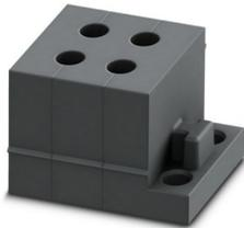
Isolatori passanti, piccoli, numero dei conduttori: 4, esecuzione: Cavo a sezione circolare, intagliato, diametro esterno conduttore: 4x 2 mm ... 3 mm, materiale: NBR, colore: nero, lunghezza: 29,5 mm, larghezza: 19,5 mm, altezza: 17 mm
