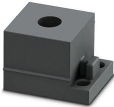
Isolatori passanti, piccoli, numero dei conduttori: 1, esecuzione: Cavo a sezione circolare, intagliato, diametro esterno conduttore: 1x 6 mm ... 7 mm, materiale: NBR, colore: nero, lunghezza: 29,5 mm, larghezza: 19,5 mm, altezza: 17 mm
