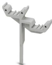
Portacartellini, inseribile nel morsetto a molla a due piani STTB 2,5, STTB 4, PTTB 2,5, PTTB 4, siglabile con UC-TM 5, UC-TMF 5, UCT-TM 5, UCT-TMF 5, ZB 5 o ZBF 5, grigio, in bianco, tipo di montaggio: Innesto, altezza del campo di testo: 10,5 mm, larghezza del campo di testo: 5 mm
