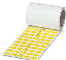
Etichetta in tessuto, Rotolo, giallo, in bianco, siglabile con: THERMOMARK E.300 (D)/600 (D), THERMOMARK ROLL 2.0, THERMOMARK ROLL, THERMOMARK ROLL X1, THERMOMARK ROLLMASTER 300/600, THERMOMARK X1.2, tipo di montaggio: colla, Numero dei cartellini singoli: 2500, altezza del campo di testo: 9 mm, larghezza del campo di testo: 15 mm
