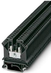
Morsetto passante, tensione nominale: 800 V, corrente nominale: 24 A, numero di connessioni: 2, tipo di connessione: Connessione a vite, Sezione di dimensionamento: 2,5 mm<sup>2</sup>, sezione: 0,2 mm<sup>2</sup> - 4 mm<sup>2</sup>, tipo di montaggio: NS 35/7,5, NS 35/15, NS 32, colore: nero
