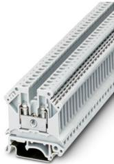
Morsetto passante, tensione nominale: 800 V, corrente nominale: 24 A, numero di connessioni: 2, tipo di connessione: Connessione a vite, Sezione di dimensionamento: 2,5 mm<sup>2</sup>, sezione: 0,2 mm<sup>2</sup> - 4 mm<sup>2</sup>, tipo di montaggio: NS 35/7,5, NS 35/15, NS 32, colore: bianco
