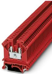
Morsetto passante, tensione nominale: 800 V, corrente nominale: 24 A, numero di connessioni: 2, tipo di connessione: Connessione a vite, Sezione di dimensionamento: 2,5 mm<sup>2</sup>, sezione: 0,2 mm<sup>2</sup> - 4 mm<sup>2</sup>, tipo di montaggio: NS 35/7,5, NS 35/15, NS 32, colore: rosso
