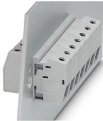
Morsetto d'esecuzione, tipo di connessione: Connessione a vite con gabbia, Connessione a vite con gabbia, numero poli: 1, corrente di carico: 57 A, sezione: 0,5 mm<sup>2</sup> - 16 mm<sup>2</sup>, direzione di connessione del conduttore alla direzione di inserzione: 0 °, larghezza: 10,1 mm, colore: grigio
