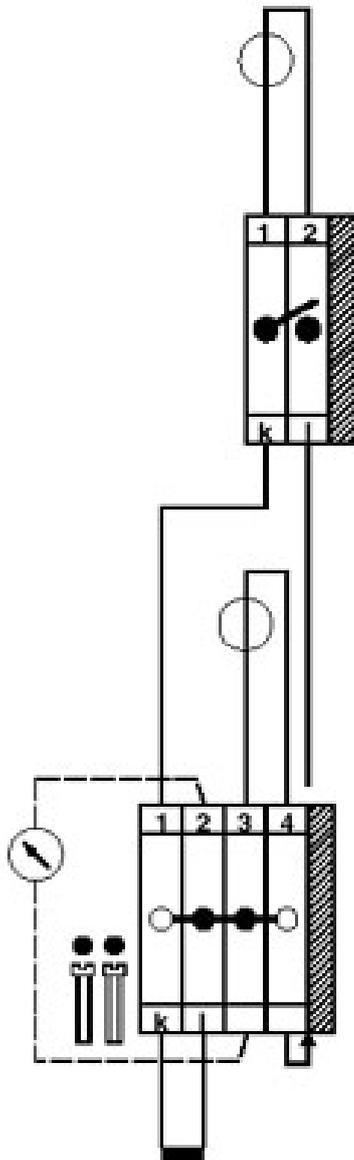
Serie di prova convertitore di corrente con presa
