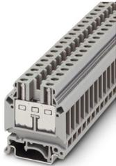
Morsetto passante, tensione nominale: 400 V, corrente nominale: 57 A, numero di connessioni: 2, tipo di connessione: Connessione a vite, 1. piano, sezione: 0,5 mm<sup>2</sup> - 10 mm<sup>2</sup>, tipo di montaggio: NS 35/7,5, NS 35/15, NS 32, colore: grigio
