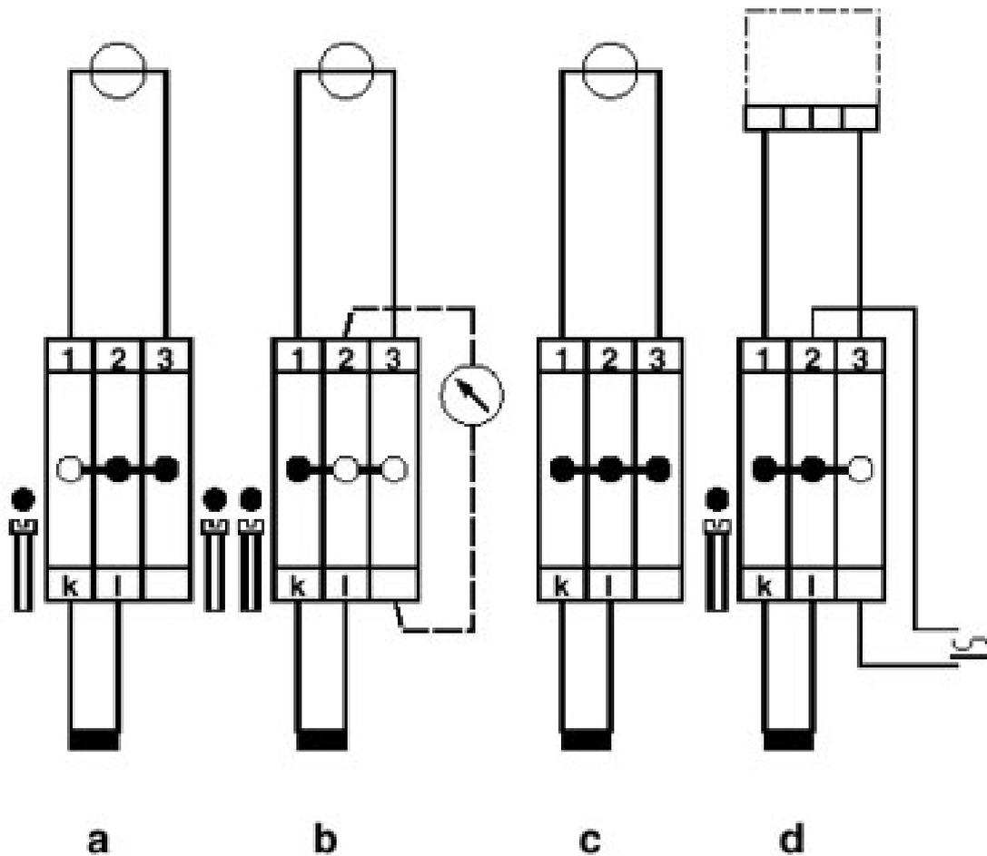
Collegamento di prova convertitore di corrente semplice
