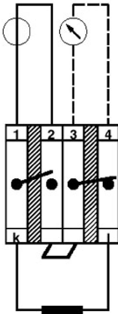
Collegamento di circuiti di prova per convertitore di corrente con piastrine orientabili
