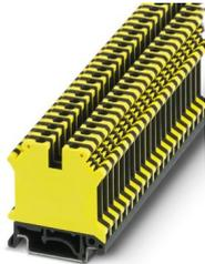
Morsetto passante, tensione nominale: 800 V, corrente nominale: 32 A, numero di connessioni: 2, numero poli: 1, tipo di connessione: Connessione a vite, sezione: 0,2 mm<sup>2</sup> - 4 mm<sup>2</sup>, tipo di montaggio: NS 35/7,5, NS 35/15, NS 32, colore: nero/giallo
