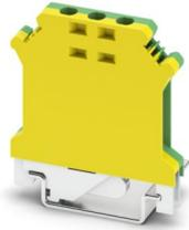
Morsetti comp. per conduttori terra, In caso di affiancamento con morsetti passanti dal profilo identico, in presenza di tensioni di isolamento 690 V, occorre impiegare una piastra terminale., numero di connessioni: 2, numero poli: 1, tipo di connessione: Connessione a vite, Sezione di dimensionamento: 4 mm<sup>2</sup>, sezione: 0,2 mm<sup>2</sup> - 4 mm<sup>2</sup>, tipo di montaggio: NS 35/7,5, NS 35/15, NS 32, colore: giallo-verde
