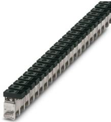
Morsetto, tensione nominale: 300 V, corrente nominale: 125 A, tipo di connessione: Connessione a vite, Sezione di dimensionamento: 35 mm<sup>2</sup>, sezione: 2,5 mm<sup>2</sup> - 35 mm<sup>2</sup>, montaggio: Barra collettore N, colore: nero
