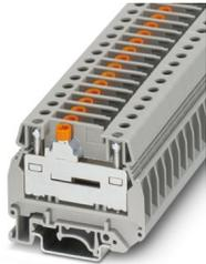
Morsetto trasversale, con blocchetto scorrevole, tensione nominale: 500 V, corrente nominale: 41 A, numero di connessioni: 2, tipo di connessione: Connessione a vite, Sezione di dimensionamento: 6 mm<sup>2</sup>, 1. piano, sezione: 0,5 mm<sup>2</sup> - 10 mm<sup>2</sup>, tipo di montaggio: NS 35/7,5, NS 35/15, NS 32, colore: grigio
