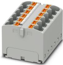
Bloque para distribución, Borna de base, tensión nominal: 450 V, corriente nominal: 32 A, número de conexiones: 12, tipo de conexión: Conexión push-in, sección: 0,2 mm<sup>2</sup> - 6 mm<sup>2</sup>, clase de montaje: enclavar en adaptador para carril, Montaje directo con una brida, Aéreo, color: gris
