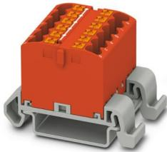
Bloque para distribución, Bloque con alineación horizontal, tensión nominal: 690 V, corriente nominal: 24 A, número de conexiones: 12, tipo de conexión: Conexión push-in, sección: 0,14 mm<sup>2</sup> - 4 mm<sup>2</sup>, clase de montaje: NS 35/7,5, NS 35/15, color: rojo
