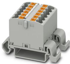
Bloque para distribución, Bloque con alineación horizontal, tensión nominal: 690 V, corriente nominal: 24 A, número de conexiones: 12, tipo de conexión: Conexión push-in, sección: 0,14 mm<sup>2</sup> - 4 mm<sup>2</sup>, clase de montaje: NS 35/7,5, NS 35/15, color: gris
