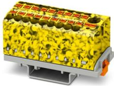
Bloque para distribución, Bloque con alineación vertical y alimentación integrada, tensión nominal: 690 V, corriente nominal: 24 A, número de conexiones: 19, tipo de conexión: Conexión push-in, Sección de dimensionamiento: 2,5 mm<sup>2</sup>, Derivación, sección: 0,14 mm<sup>2</sup> - 4 mm<sup>2</sup>, Conexión push-in, Conexión colectiva, Sección de dimensionamiento: 6 mm<sup>2</sup>, sección: 0,5 mm<sup>2</sup> - 10 mm<sup>2</sup>, clase de montaje: NS 35/7,5, NS 35/15, color: negro/amarillo
