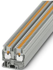
Miniborna de paso, tensión nominal: 500 V, corriente nominal: 24 A, número de conexiones: 2, número de polos: 1, tipo de conexión: Conexión push-in, Sección de dimensionamiento: 2,5 mm<sup>2</sup>, 1er piso, sección: 0,14 mm<sup>2</sup> - 4 mm<sup>2</sup>, clase de montaje: NS 15, color: gris
