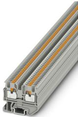
Miniborna de paso, tensión nominal: 500 V, corriente nominal: 17,5 A, número de conexiones: 2, tipo de conexión: Conexión push-in, Sección de dimensionamiento: 1,5 mm<sup>2</sup>, 1er piso, sección: 0,14 mm<sup>2</sup> - 1,5 mm<sup>2</sup>, clase de montaje: NS 15, color: gris
