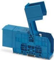
Borne de conexión por espárrago, tensión nominal: 1500 V, corriente nominal: 309 A, número de conexiones: 2, número de polos: 1, tipo de conexión: Conexión por espárrago, Sección de dimensionamiento: 150 mm<sup>2</sup>, 1er piso, clase de montaje: NS 35/7,5, NS 35/15, atornillado directo, color: azul
