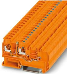
Borna de actuador/sensor de proximidad, Borna de alimentación, tensión nominal: 24 V, corriente nominal: 13,5 A, número de conexiones: 2, tipo de conexión: Conexión push-in, Sección de dimensionamiento: 2,5 mm<sup>2</sup>, sección: 0,2 mm<sup>2</sup> - 4 mm<sup>2</sup>, clase de montaje: NS 35/7,5, NS 35/15, color: naranja
