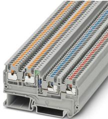
Borna de actuador/sensor de proximidad, Con indicación luminosa verde, tensión nominal: 250 V, corriente nominal: 13,5 A, número de conexiones: 4, tipo de conexión: Conexión push-in, Sección de dimensionamiento: 1,5 mm<sup>2</sup>, sección: 0,14 mm<sup>2</sup> - 1,5 mm<sup>2</sup>, clase de montaje: NS 35/7,5, NS 35/15, color: gris
