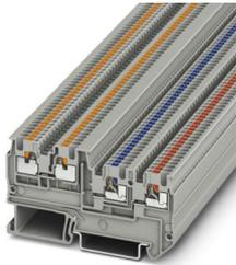
Borna de actuador/sensor de proximidad, tensión nominal: 250 V, corriente nominal: 13,5 A, número de conexiones: 4, tipo de conexión: Conexión push-in, Sección de dimensionamiento: 1,5 mm<sup>2</sup>, sección: 0,14 mm<sup>2</sup> - 1,5 mm<sup>2</sup>, clase de montaje: NS 35/7,5, NS 35/15, color: gris
