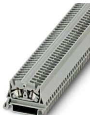
Miniborna de paso, tensión nominal: 800 V, corriente nominal: 24 A, número de conexiones: 2, tipo de conexión: Conexión por resorte, Sección de dimensionamiento: 2,5 mm<sup>2</sup>, 1er piso, sección: 0,08 mm<sup>2</sup> - 4 mm<sup>2</sup>, clase de montaje: NS 35/7,5, NS 35/15, color: gris
