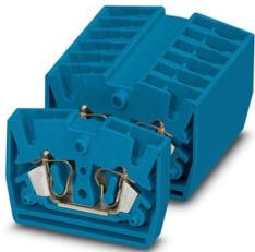
Miniborna de paso, Montaje en combinación con borne de brida o borne de espiga de encaje, tensión nominal: 800 V, corriente nominal: 24 A, número de conexiones: 2, tipo de conexión: Conexión por resorte, Sección de dimensionamiento: 2,5 mm<sup>2</sup>, 1er piso, sección: 0,08 mm<sup>2</sup> - 4 mm<sup>2</sup>, clase de montaje: otros, color: azul
