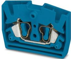
Miniborna de paso, tensión nominal: 800 V, corriente nominal: 24 A, número de conexiones: 2, tipo de conexión: Conexión por resorte, Sección de dimensionamiento: 2,5 mm<sup>2</sup>, 1er piso, sección: 0,08 mm<sup>2</sup> - 4 mm<sup>2</sup>, clase de montaje: En placa de montaje, color: azul
