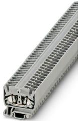
Miniborna de paso, tensión nominal: 800 V, corriente nominal: 24 A, número de conexiones: 2, tipo de conexión: Conexión por resorte, Sección de dimensionamiento: 2,5 mm<sup>2</sup>, sección: 0,08 mm<sup>2</sup> - 4 mm<sup>2</sup>, clase de montaje: NS 15, color: gris
