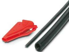
Manguera de protección, material: PA, resistente a los rayos ultravioleta: sí, flexible, índice de protección: IP40, color: negro, clase de inflamabilidad según UL 94: HB, diámetro interior: 16,5 mm, Longitud total: 10 m
