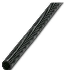
Manguera de protección, material: PA 6, resistente a los rayos ultravioleta: sí, flexible, índice de protección: IP68, color: negro, clase de inflamabilidad según UL 94: HB, diámetro interior: 10 mm, Longitud total: 50 m
