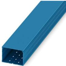
Canal de cableado para la instalación y el montaje en armarios de control, azul, formado por parte superior e inferior, ancho: 120 mm, altura: 80 mm, longitud: 2000 mm
