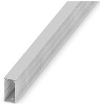
Canal de cableado para la instalación y el montaje en armarios de control, gris, formado por parte superior e inferior, ancho: 40 mm, altura: 80 mm, longitud: 2000 mm
