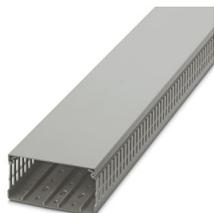
Canal de cableado para la instalación y el montaje en armarios de control, gris, formado por parte superior e inferior, ancho: 120 mm, altura: 60 mm, longitud: 2000 mm
