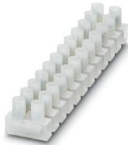
Regleta de bornes Europa de poliamida, transparente, para conectar conductores rígidos y flexibles con y sin punteras con una sección de 1 a 10 mm<sup>2</sup>
