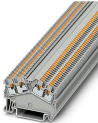
Borne de paso, tensión nominal: 500 V, corriente nominal: 17,5 A, número de conexiones: 4, tipo de conexión: Conexión push-in, Sección de dimensionamiento: 1,5 mm<sup>2</sup>, 1er piso, sección: 0,14 mm<sup>2</sup> - 1,5 mm<sup>2</sup>, clase de montaje: NS 35/7,5, NS 35/15, color: gris
