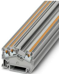
Borne de paso, tensión nominal: 500 V, corriente nominal: 17,5 A, número de conexiones: 3, tipo de conexión: Conexión push-in, Sección de dimensionamiento: 1,5 mm<sup>2</sup>, 1er piso, sección: 0,14 mm<sup>2</sup> - 1,5 mm<sup>2</sup>, clase de montaje: NS 35/7,5, NS 35/15, color: gris
