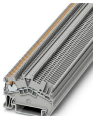
Borne de paso, tensión nominal: 500 V, corriente nominal: 17,5 A, número de conexiones: 2, número de polos: 1, tipo de conexión: Conexión push-in / conexión enchufable, Sección de dimensionamiento: 1,5 mm<sup>2</sup>, 1er piso, sección: 0,14 mm<sup>2</sup> - 1,5 mm<sup>2</sup>, clase de montaje: NS 35/7,5, NS 35/15, color: gris
