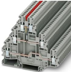
Borne para componentes, La corriente y la tensión se determinan mediante la indicación luminosa empleada., tensión nominal: 24 V, corriente nominal: 19 A, tipo de conexión: Conexión por tornillo, Sección de dimensionamiento: 2,5 mm<sup>2</sup>, sección: 0,14 mm<sup>2</sup> - 4 mm<sup>2</sup>, clase de montaje: NS 35/7,5, NS 35/15, color: gris
