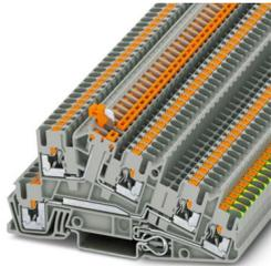
Borne de tierra para distribución, tensión nominal: 400 V, corriente nominal: 24 A, Conexión push-in, Sección de dimensionamiento: 2,5 mm<sup>2</sup>, sección: 0,14 mm<sup>2</sup> - 4 mm<sup>2</sup>, Conexión push-in, Sección de dimensionamiento: 1,5 mm<sup>2</sup>, sección: 0,14 mm<sup>2</sup> - 4 mm<sup>2</sup>, clase de montaje: NS 35/7,5, NS 35/15, color: gris
