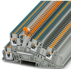
Borne de piso de distribución, tensión nominal: 400 V, corriente nominal: 24 A, Conexión push-in, Sección de dimensionamiento: 2,5 mm<sup>2</sup>, sección: 0,14 mm<sup>2</sup> - 4 mm<sup>2</sup>, Conexión push-in, Sección de dimensionamiento: 1,5 mm<sup>2</sup>, sección: 0,14 mm<sup>2</sup> - 4 mm<sup>2</sup>, clase de montaje: NS 35/7,5, NS 35/15, color: gris
