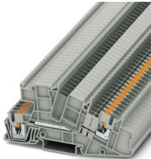
Borne de piso de distribución, tensión nominal: 400 V, corriente nominal: 24 A, Conexión push-in, Sección de dimensionamiento: 2,5 mm<sup>2</sup>, sección: 0,14 mm<sup>2</sup> - 4 mm<sup>2</sup>, clase de montaje: NS 35/7,5, NS 35/15, color: gris
