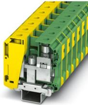
Borna de tierra, número de conexiones: 2, número de polos: 1, tipo de conexión: Conexión por tornillo, Sección de dimensionamiento: 70 mm<sup>2</sup>, sección: 16 mm<sup>2</sup> - 95 mm<sup>2</sup>, tipo de sujeción: Pie PE con tornillo de fijación, M6, clase de montaje: NS 35/7,5, NS 35/15, NS 35/15-2,3, NS 32, color: amarillo-verde
