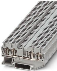
Borne de paso, tensión nominal: 500 V, corriente nominal: 17,5 A, número de conexiones: 4, tipo de conexión: Conexión por resorte, Sección de dimensionamiento: 1,5 mm<sup>2</sup>, 1er piso, sección: 0,08 mm<sup>2</sup> - 1,5 mm<sup>2</sup>, clase de montaje: NS 35/7,5, NS 35/15, color: gris
