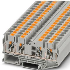
Borne de paso, tensión nominal: 1000 V, corriente nominal: 41 A, número de conexiones: 4, tipo de conexión: Conexión push-in, Sección de dimensionamiento: 6 mm<sup>2</sup>, sección: 0,5 mm<sup>2</sup> - 10 mm<sup>2</sup>, clase de montaje: NS 35/7,5, NS 35/15, color: gris
