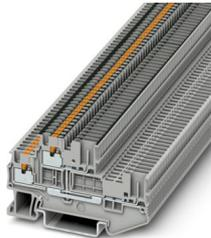
Borna de doble piso, La corriente y la tensión son determinadas por el conector empleado., con empalmadores de potencial, tensión nominal: 500 V, corriente nominal: 16 A, tipo de conexión: Conexión push-in / conexión enchufable, 1er y 2º piso, Sección de dimensionamiento: 1,5 mm<sup>2</sup>, sección: 0,14 mm<sup>2</sup> - 1,5 mm<sup>2</sup>, clase de montaje: NS 35/7,5, NS 35/15, color: gris
