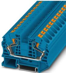
Borne de paso, tensión nominal: 1000 V, corriente nominal: 76 A, número de conexiones: 2, tipo de conexión: Conexión push-in, Sección de dimensionamiento: 16 mm<sup>2</sup>, sección: 0,5 mm<sup>2</sup> - 25 mm<sup>2</sup>, clase de montaje: NS 35/7,5, NS 35/15, color: azul
