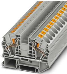
Borne de paso, tensión nominal: 1000 V, corriente nominal: 76 A, número de conexiones: 2, tipo de conexión: Conexión push-in, Sección de dimensionamiento: 16 mm<sup>2</sup>, sección: 0,5 mm<sup>2</sup> - 25 mm<sup>2</sup>, clase de montaje: NS 35/7,5, NS 35/15, color: gris
