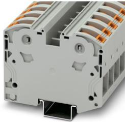
Borne de corriente, tensión nominal: 1000 V, corriente nominal: 125 A, número de conexiones: 2, tipo de conexión: Conexión PowerTurn, Sección de dimensionamiento: 35 mm<sup>2</sup>, sección: 2,5 mm<sup>2</sup> - 35 mm<sup>2</sup>, clase de montaje: NS 35/15, color: gris
