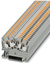
Borne de paso, tensión nominal: 800 V, corriente nominal: 24 A, número de conexiones: 4, tipo de conexión: Conexión push-in, Sección de dimensionamiento: 2,5 mm<sup>2</sup>, 1er piso, sección: 0,14 mm<sup>2</sup> - 4 mm<sup>2</sup>, clase de montaje: NS 35/7,5, NS 35/15, color: gris
